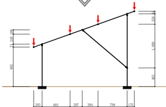
設計した架台から構造解析用モデルを作ります
